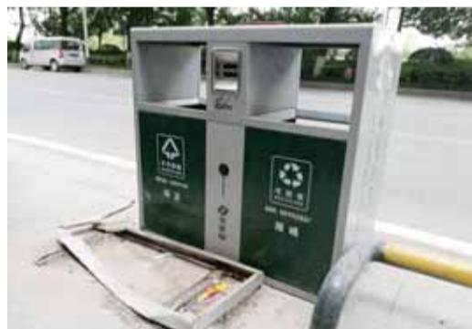
果皮箱基座断裂变形
