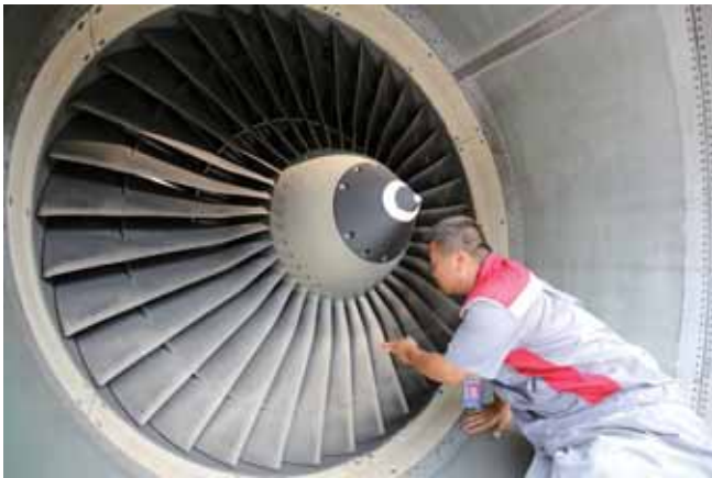
机务师进入发动机对叶片进行逐个检查
