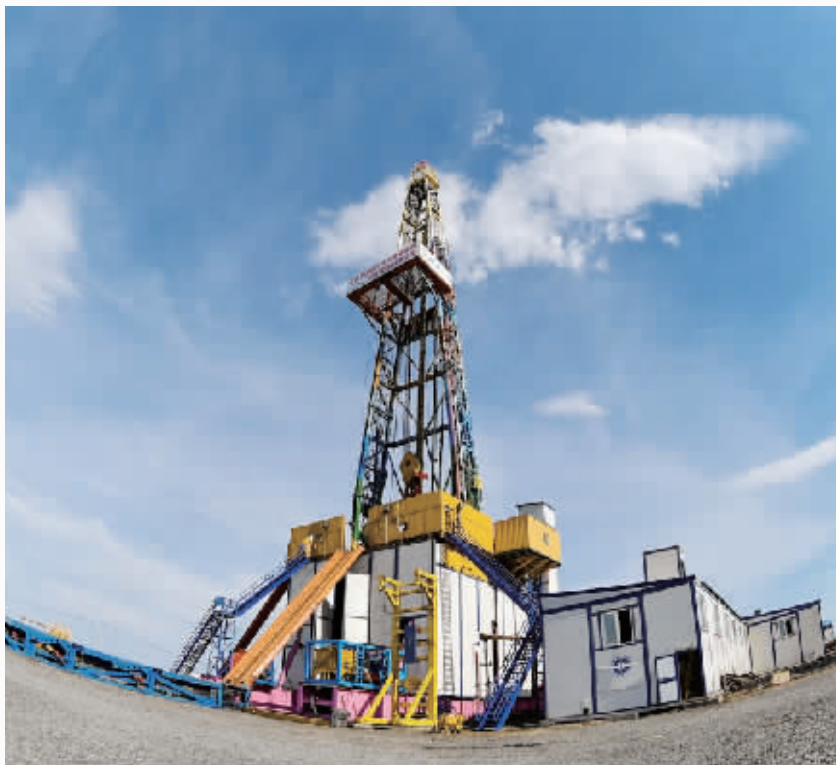
这是在松科二井拍摄的“地壳一号”万米钻机整机系统
