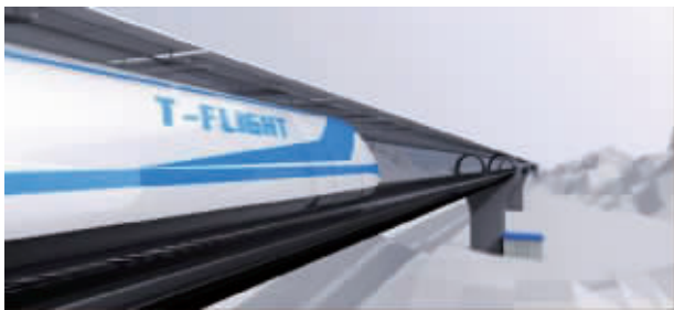
“高速飞行列车”利用超导磁悬浮技术和真空管道，致力于实现超声速的“近地飞行”。（效果图）
