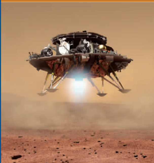
着陆巡视器与环绕器分离,经过气动外形减速、降落伞减速、反推发动机减速,展开着陆腿,缓冲着陆到火星表面,火星车释放,开展巡视探测。环绕器在轨道上进行科学探测,并为火星车提供对地数据中继服务。
