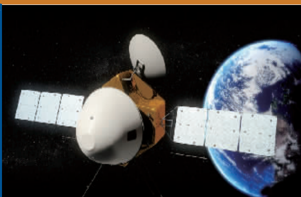
火星探测器与运载火箭分离,建立巡航姿态,飞行到达火星,被火星引力捕获,成为环绕火星飞行的探测器。
