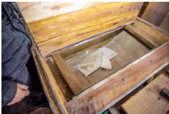
下雨的时候,雨水会经过两边卡槽经过船侧身的小孔流出。
