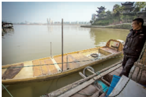
这是刘得志 2013 年制造的船。已经经过两年多时间,颜色还保持如新。一般情况下,传统木船使用三年,船身将会变成深黑色,得重新刷油。
