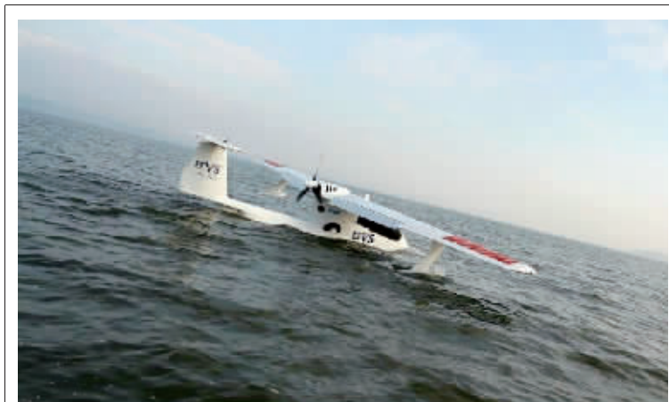
军民融合科技创新再传捷报!12月上旬,一架代号为“U650”的大型水陆两用无人机,在江苏某水域滑跑200余米后起飞,在大雾和强侧风条件下经过30分钟试验飞行,在事先预设区域平稳降落,成功完成首次试飞。该机身长6米、翼展12米,具有惊人的17:1大滑翔比。
