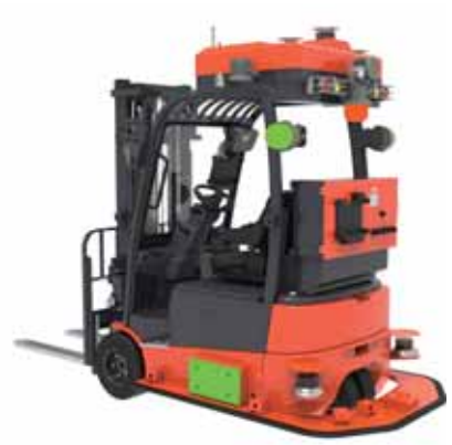
衡阳合力防爆电动平衡重式AGV。
