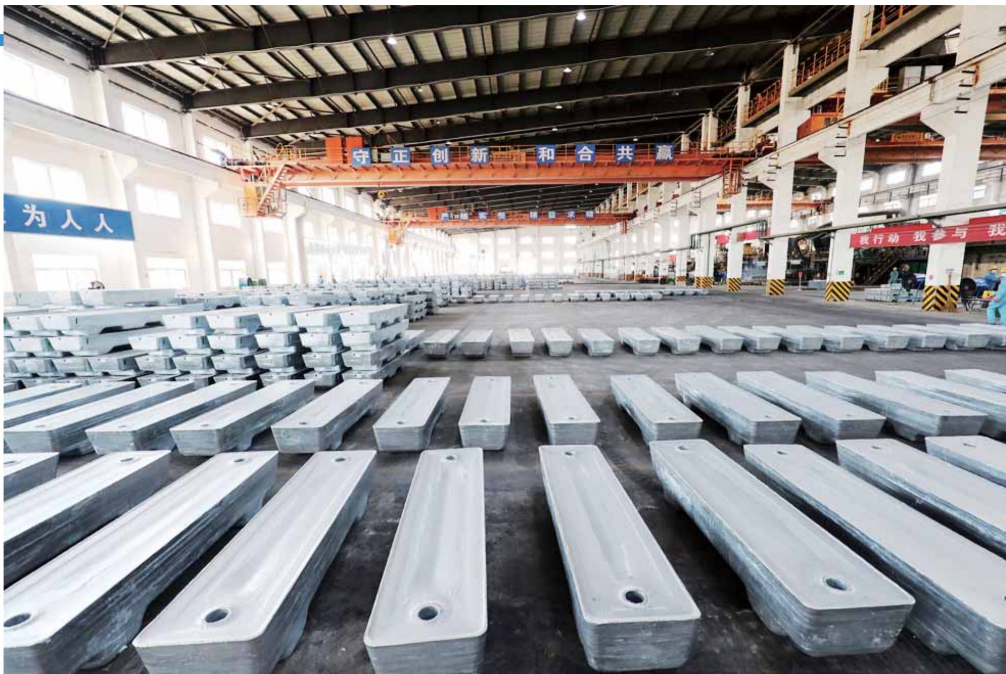
水口山铜铅锌产业基地株冶新成品加工车间，每天出产纯度99.996%的锌锭达600吨。 ■罗盟 摄
