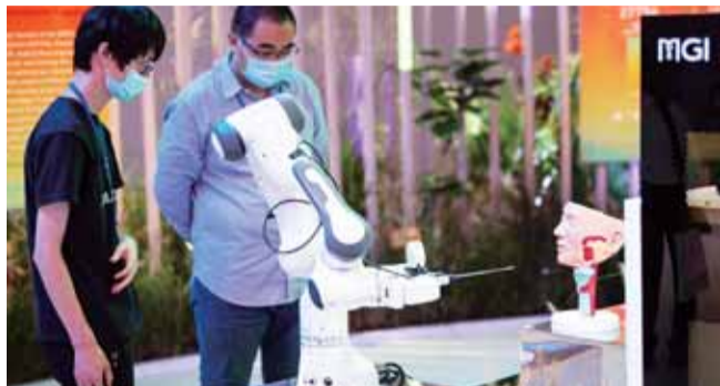
9月4日,在国家会议中心中国服务贸易发展成就展上,观众参观全自动核酸采样机器人。
