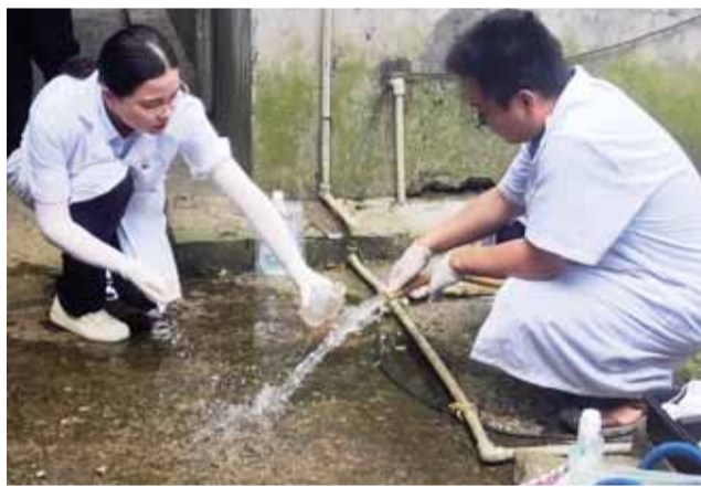
水质监测人员现场抽取水样
