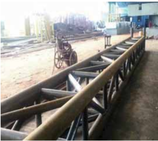
新款限高架为双层全钢结构。胡亚华 摄
